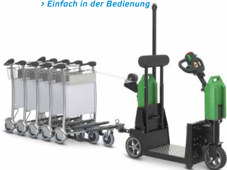
SCOOTER M-1000 mit Zugadapter, inkl. Seilwinde
